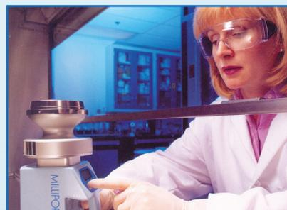
„M AIR T tester” инструментот се користи за микробиолошка анализа на амбиенталниот воздух, при што има капацитет да зема примерок 1000l воздух за околу 7min. Инструментот е преносен, може да работи на батерии кои се полнат и имаат капацитет од 7h активна работа.
